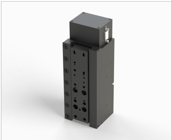
■ Mit Hilfe unserer **motorischen Fokusachse** realisieren wir eine motorische Objektivfokussierung: Nicht der Scanningtisch, sondern die wesentlich leichtere Optik wird verfahren. So profitiert Ihr System von schnellen Fokusphasen und einer geringen Belastung der Mechanik.
